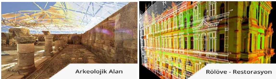
Resim 7. Arkeolojik Alan ve Binanın Lazer Taraması ( https://www.deltalidar.com/Yersel-Lazer-Tarama.aspx )
